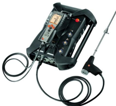
Slika 1. Gasni analizator Testo 350, [14]
