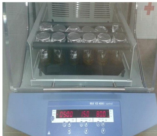
Slika 1 - Inkubator šejker za ekstrakciju na povišenoj temperaturi
