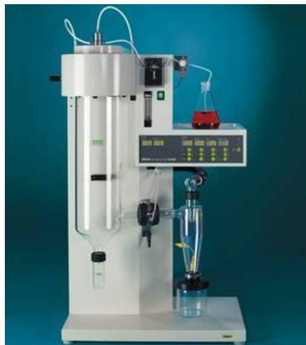
Slika 3. Laboratorijska sprej sušnica, model B-290, BUCHI (Švajcarska)
