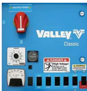
Sl. 4. Kontrolna kutija sa "procentualnim programatorom"
