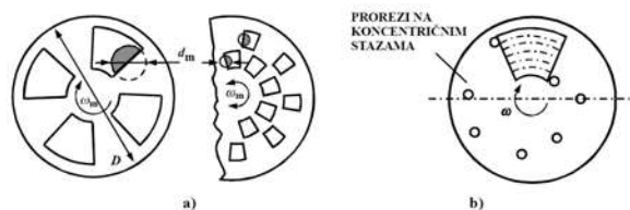
Slika 2. Optomehanički modulatori: a) integralna modulacija sa jednokanalnim i dvokanalnim diskom, b) disk sa prorezima za prostornu modulaciju
