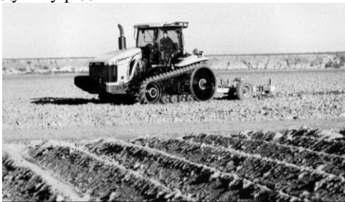
Слика 3. Разривач са класичним радним органима
