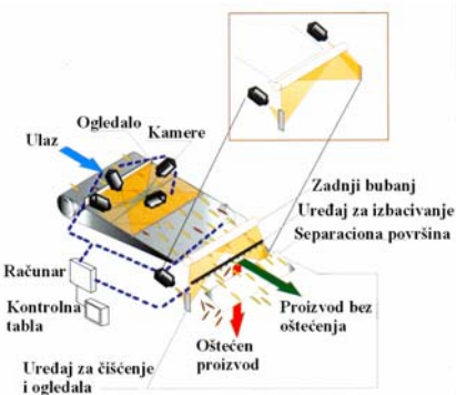
Sl. 4. Optički sorter sa potpunim snimanjem proizvoda
