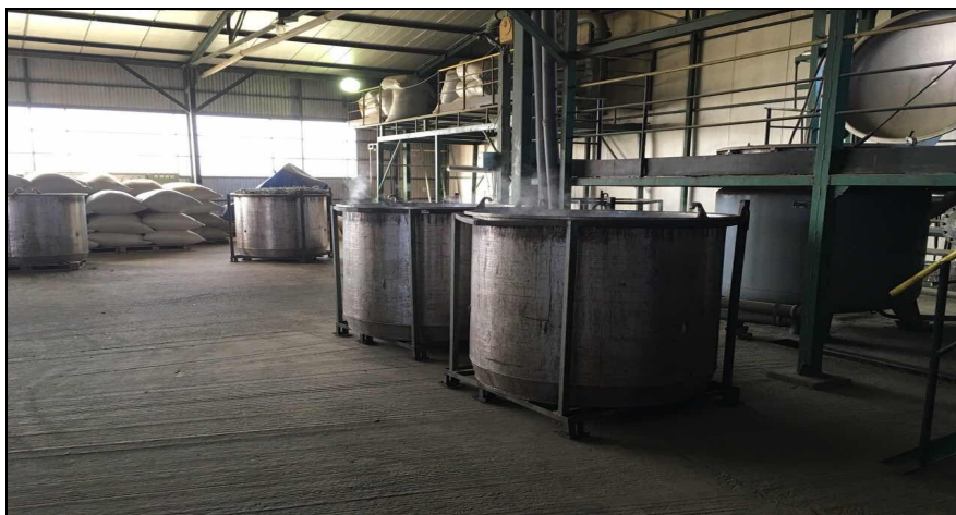
Slika 3. Destilacija vodenom parom radi dobijanja eteričnog ulja, destilerija u Bavaništu Picture 3. The steam distillation to obtain essential oil, distillery in Bavaniste
