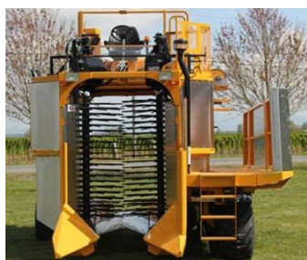
Korvan 9000 za berbu maline Korvan 9000, specified for raspberry
