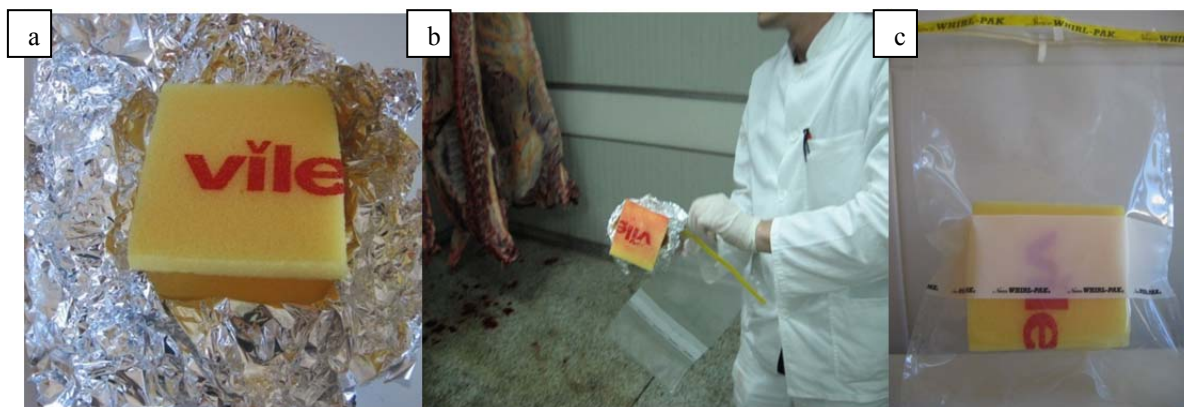
Slika 4 - Aseptični celulozni sunđer korišćeni za uzorkovanje kože i trupa: pripremljeni za uzorkovanje (a), tokom uzorkovanja (b) i tokom obrade uzorka u laboratoriji (c)
