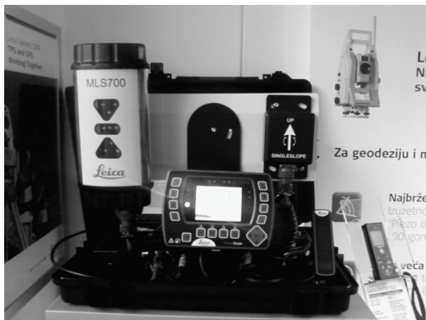
Sl.5. Laserski sistem za upravljanje radom skreperskog ravnjača (Leica Power Grade)
