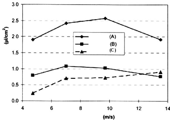
Sl. 3. Deponovana količina zaštitne tečnost pri brzini kretanja ogregata od 5,8 km/h
