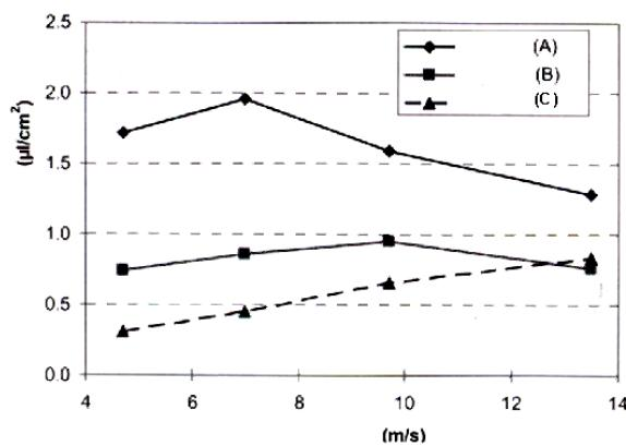
Sl. 4. Deponovana količina zaštitne tečnost pri brzini kretanja ogregata od 5,8 km/h
