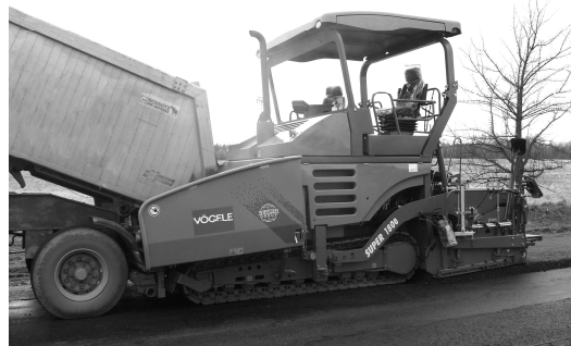
Sl. 8. Mašina za razastiranje asfalta Vogelega Super 1800DE [21]
