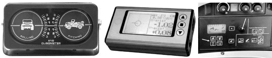
Sl. 9. Prikaz informacija o položaju mašine prema površini podloge na centralnom displeju kod integrisanih sistema samohodnih mašina i traktora [18], [36], [40]
