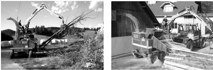
Sl. 6. Mašine za sitnjenje prikupljene biomase drveta [4], [13]
