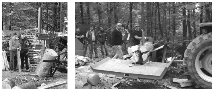
Sl. 8. Vertikalna i horizontalna mašina za sečenje drva dužine do 100 cm [1]
