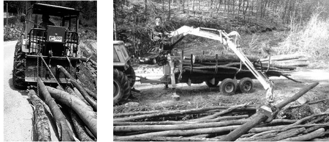
Sl. 5. Izvlačenje drveta sa vitlom i transport sa prikolicom
