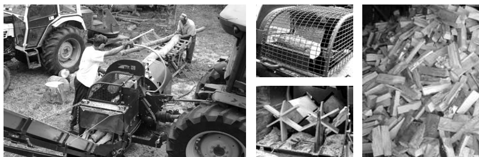
Sl. 9. Mašina za rezanje i cepanje drva do prečnika od 35 cm [1]
