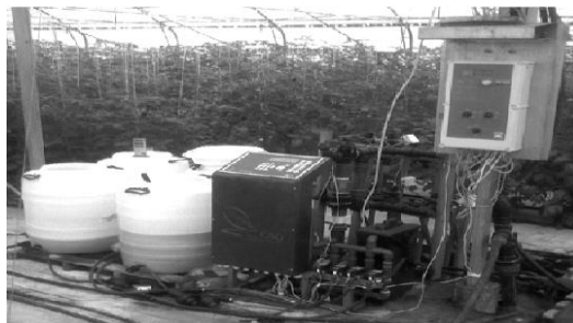
Sl. 18. Kontrolna jedinica FX 200 (model IZ2V30) sa mikser mašinom, ventilima i sensorima, Zeleni hit 2007.
