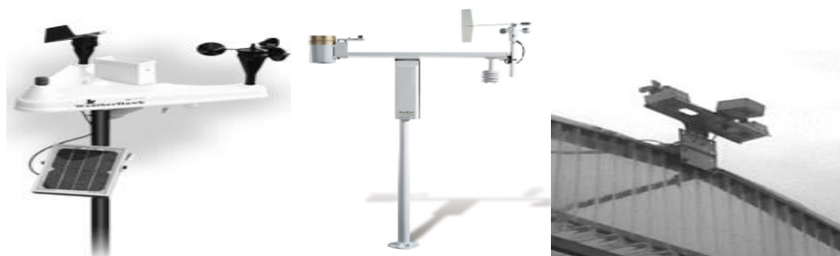
Sl. 6. Tipovi meteoroloških stanica: a) WS Pro LT, b) WS Pro [28], c) Zeleni hit, 2007
