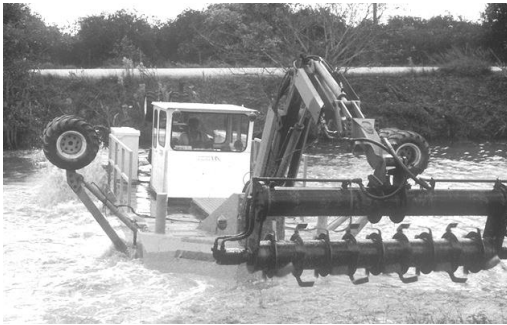
Сл. 4. Машина за култивирање дна аквасистема
