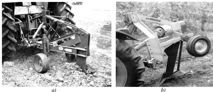
Sl. 4. Podrivači u agregatu sa traktorom: a) podrivač sa pasivnim radnim organom u radu; b) podrivač sa aktivnim u transportnom položaju
