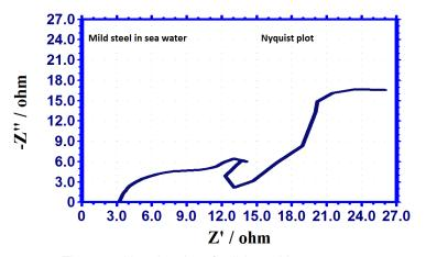
Figure 6. Nyquist plot of mild steel in seawater Slika 6. Nyquist-ova kriva za meki čelik u morskoj vodi
