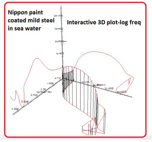
Figure 11. Interactive 3D-log freq plot of paint coated mild steel in seawater Slika 11. Interaktivni 3 D-log freq dijagram mekog čelika premazanog bojom u morskoj vodi
