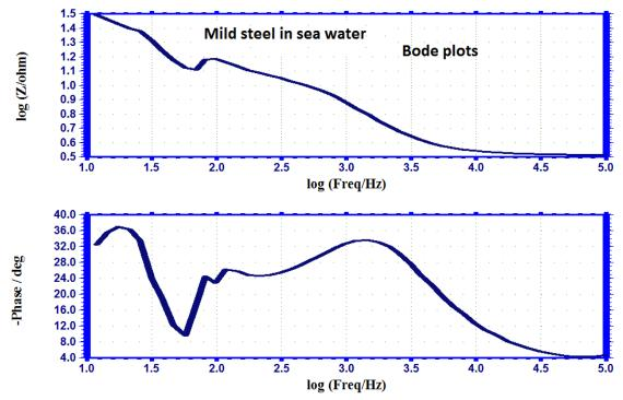
Figure 7. Bode plot of mild steel in seawater Slika 7. Bode-ove krive za meki čelik u morskoj vodi
