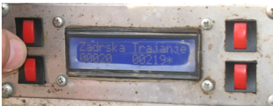
Сл. 48. Изглед екрана и тастатуре електронске управљачке јединице уређаја ЕУКУ-01.
