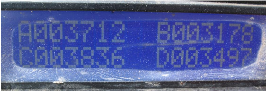
Сл. 49. Приказ броја посејаних зрна за сваку од сетвених секција.
