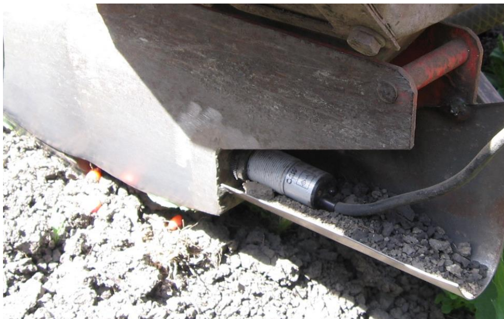
Сл. 14. Положај фотоелектричног сензора у отварачу бразде
