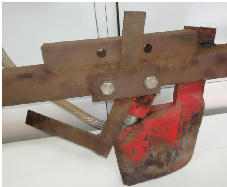
Сл. 42. Начин повезивања загртача и зглобног носача
