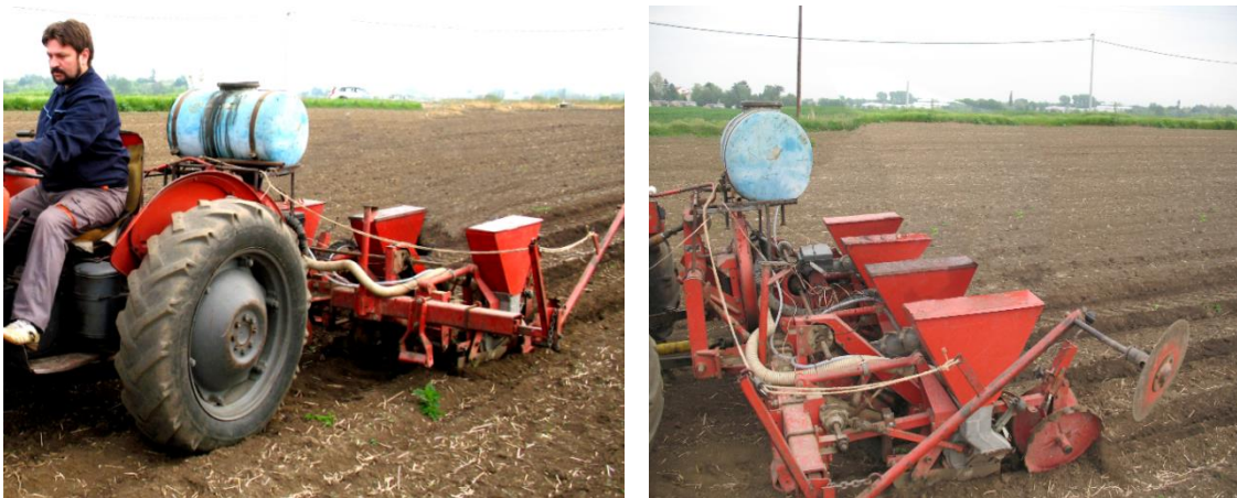
Сл. 34. Положај резервоара за течно стартно ђубриво на сејалици.
