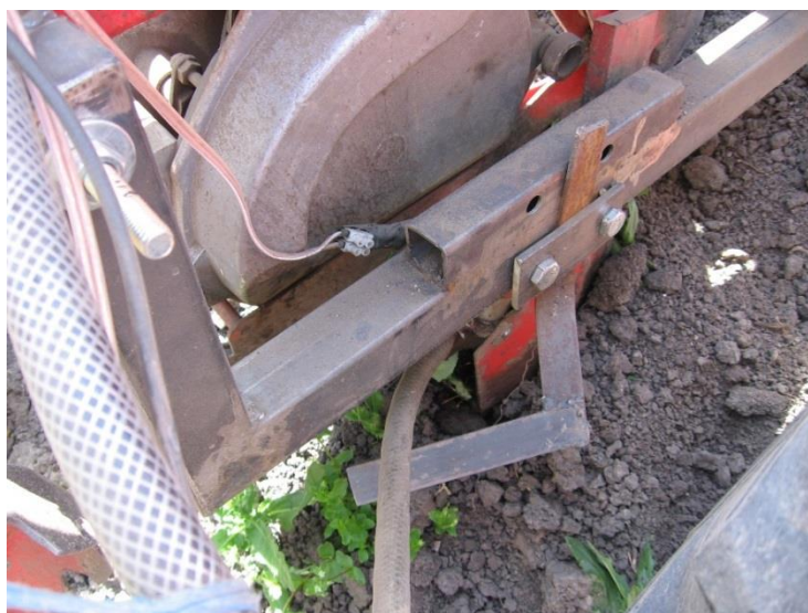
Сл. 20. Електрични проводник и флексибилна цев високог притиска
