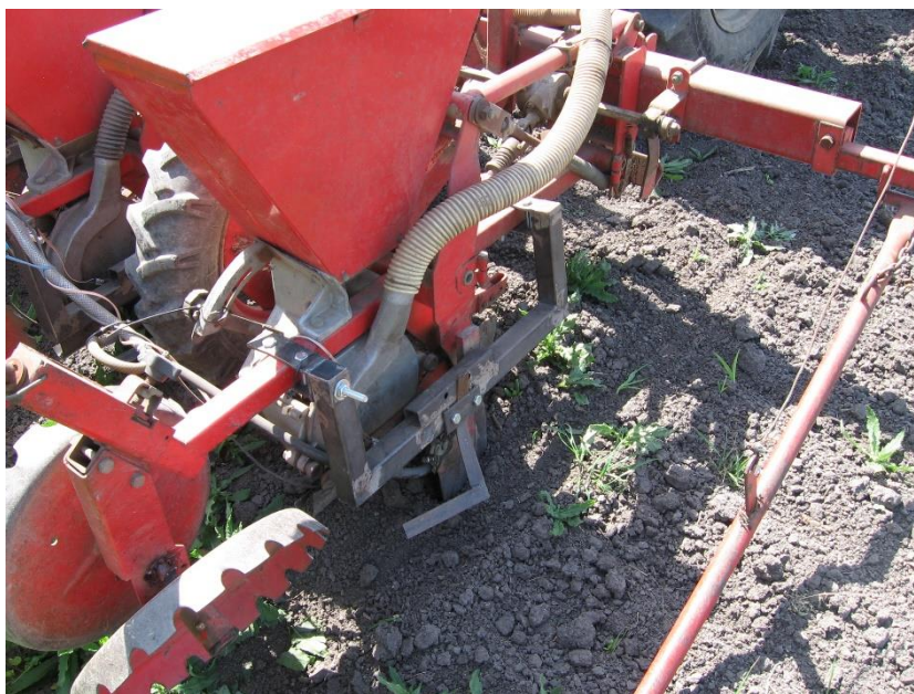
Сл. 43. Изглед модификоване сетвене секције сејалице ИМТ-634.454
