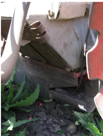
Сл. 18. Положај фотоелектричног сензора уређаја ЕУКУ-01 испод сетвеног апарата сејалице ИМТ-634.454
