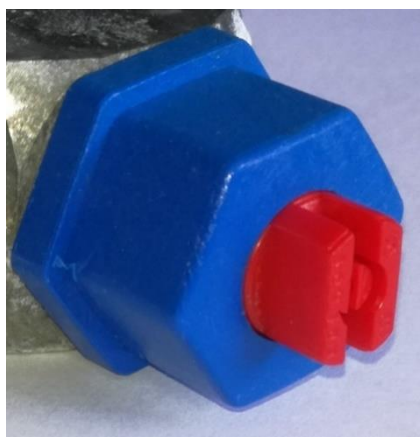
Сл. 26. Изглед распрскивача електричне бризгачке уређаја ЕУКУ-01
