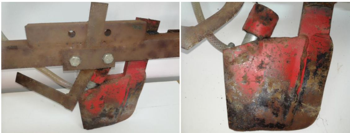
Сл. 36. Изглед улагача (отварача бразде) за уношење течног стартног ђубрива
