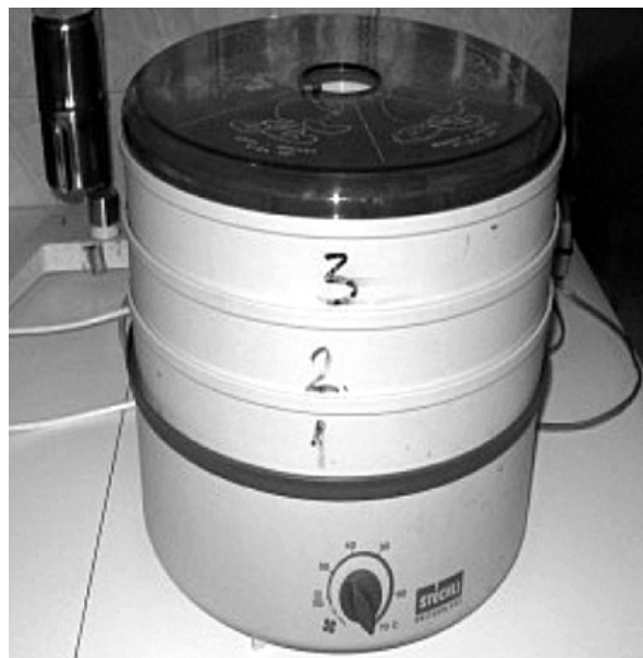
Sl. 1. Laboratorijski dehidrator Stöckli sa tri lese Laboratory dehydrator Stöckli with three mesh trays
