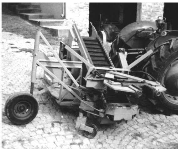
Sl. 1. Izgled ispitivanog tresaća bez sabirnih platana
